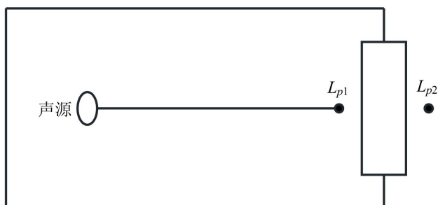
图 4-1 室内声源等效为室外声源图例
